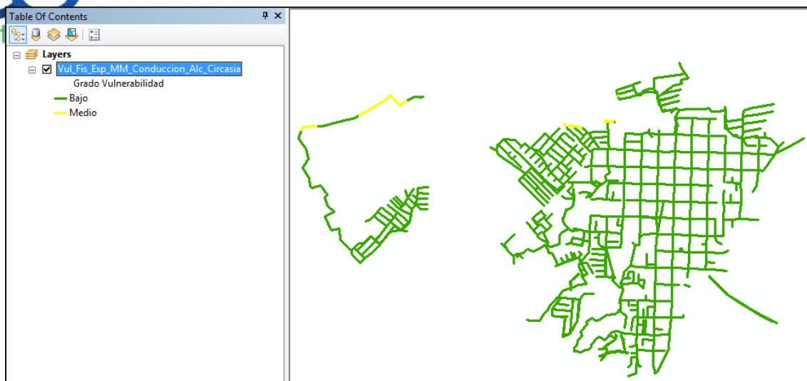
Ilustración 34 Vulnerabilidad física por exposición a movimientos en masa para el sistema de alcantarillado en el municipio de Circasia. Fuente: Elaboración propia - 2019.
