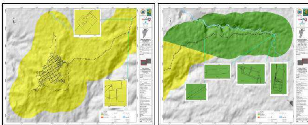
Ilustración 11. Amenaza por contaminación (cenizas volcánicas por actividad del volcán Machín) - Sistema de Acueducto. Municipio de Filandia. Fuente: Elaboración propia - 2019.
